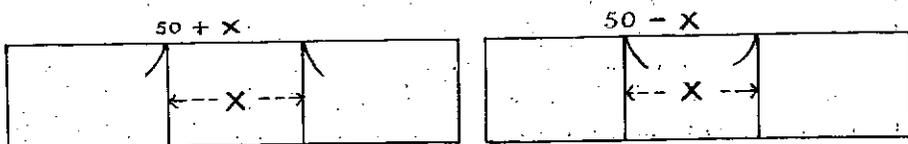
La próxima huinchada que comience en un extremo de la base, no tiene corrección y a cada huinchada corresponde el X medido a la planchita de atrás, pero basta aplicar el balance de las X al resultado.
